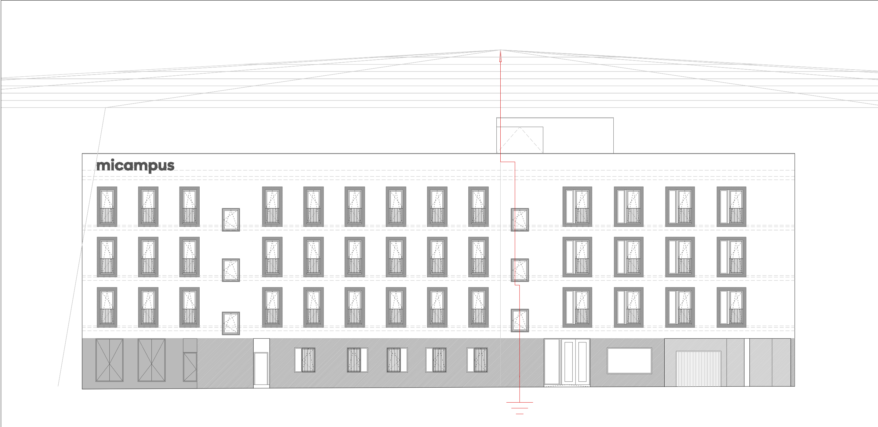
ALZADO. LOCALIZACIÓN DEL PARARRAYOS
